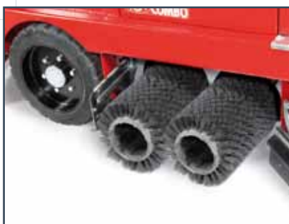
RULLI CONTROROTANTI CON ECCEZIONALE CAPACITA' DI SPAZZAMENTO E LAVAGGIO CONTEMPORANEO COUNTER-ROTATING ROLLER BRUSHES EXCEPTIONAL ABILITY TO SWEEP AND WASH CONTEMPORANEOUSLY
