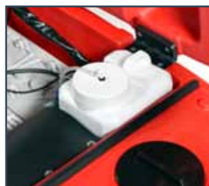
ON BOARD DETERGENT DISPENSER ON-BOARD- DOSIERANLAGE FÜR REINIGUNGSMITTEL ON-BOARD DOSEERSYSTEEM
