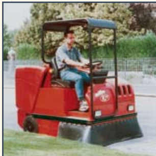
CANOPY, HEADLIGHTS AND DUST CONVEYOR FAHRERSCHUTZDACH, SCHEINWERFER UND SEITENBESENABDECKUNG OVERDEKING, KOPLAMPEN EN STOFGELEIDER
